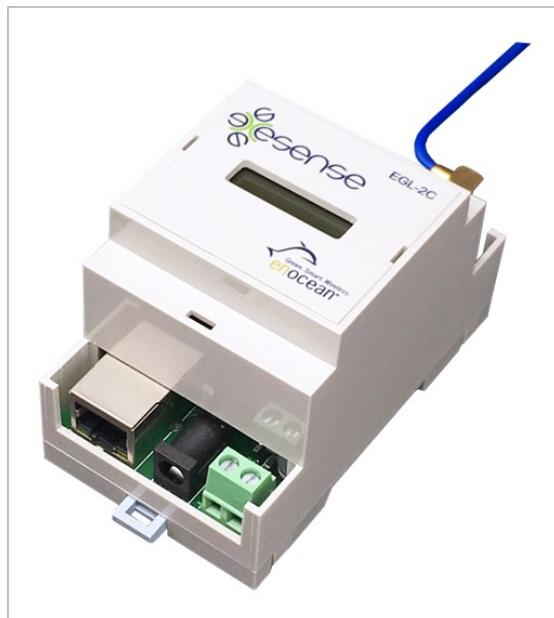
EGLe имеет высокочастотный SMA разъем, к которому подключается штатная миниатюрная угловая антенна или опционально выносные ( до 10 м кабель) антенны повышенной чувствительности.
